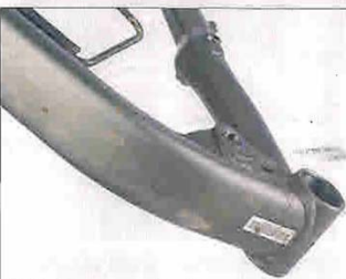
In Topzustand: Dem anodisierten Rahmen sieht man die Dauertestbelastung nicht an.
