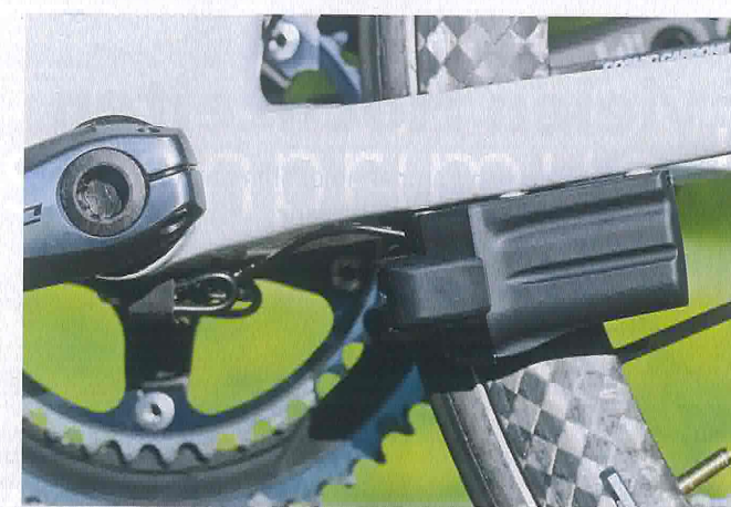
Giant platziert den Akku für die Stromversorgung dezent unter der linken Kettenstrebe
